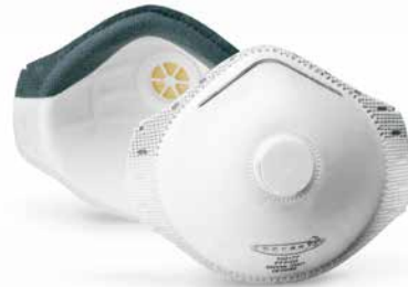
art. 102177N CE DPI 3ª categoria facciale filtrante FFP2D con valvola peso: 16,2 gr UNI EN 149:2001+A1:2009
