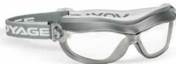
art. 2012G-IA antiappannamento CE DPI 2ª categoria montatura: colore grigio lente: indoor/outdoor marcatore oculare: S-1.7 WW 1F UNI EN 166 - UNI EN 172
